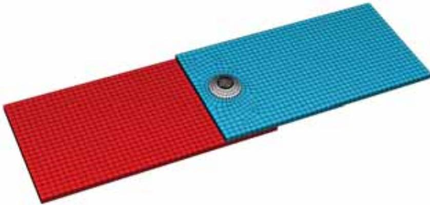
Abb. 12: 3D-Finite Element Model der genieteten Verbindung
