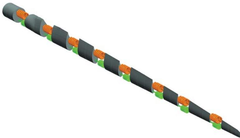
Abb. 4: Diskretisiertes Modell des Rotorblattes
