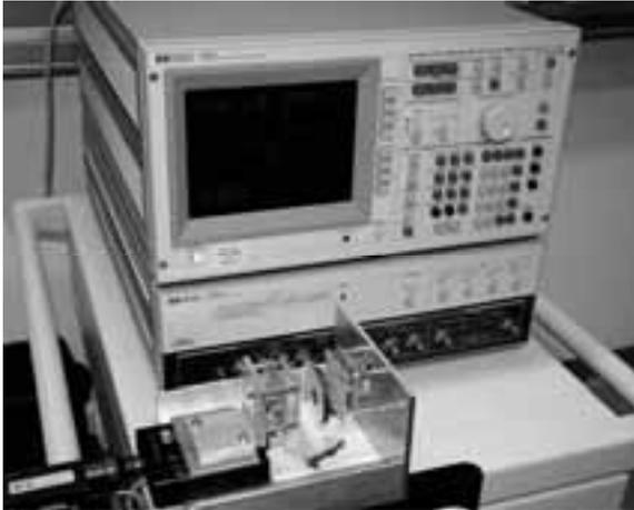
Abb. 3: Impedanzanalysator mit Aufnahmeeinheit für Piezowandler
