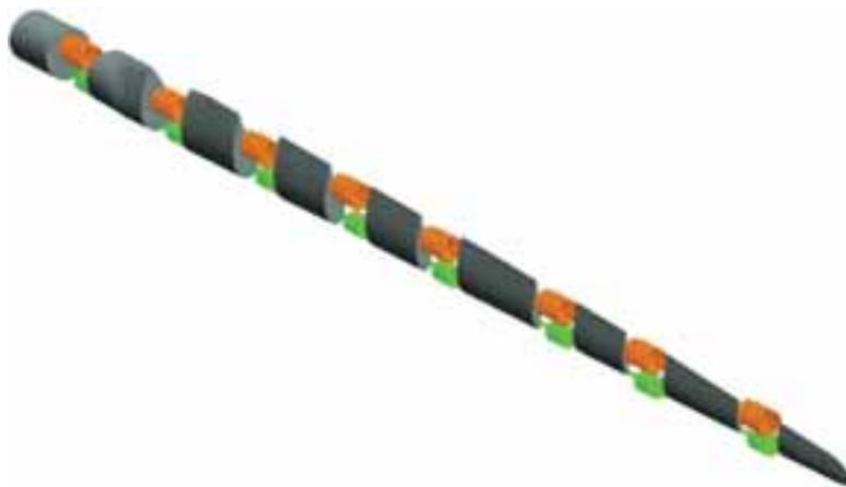
Abb. 4: Diskretisiertes Modell des Rotorblattes
