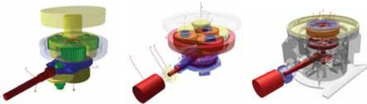
Abb. 7: Simulationsmodelle verschiedener Rollenmühlen
