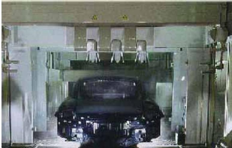
Abb. 9: Automobil Lackierprozess mit Hochrotationszerstäubern, montiert auf einer Dachmaschine
