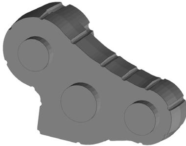
Abb. 1: Getriebegehäuse
