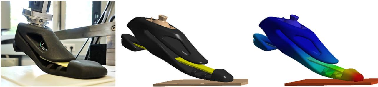
Abb. 2: Experimentelle (links) und virtuelle Prüfung (mittig: Aufbau und rechts: Belastung) eines 3D-gedruckten Prothesenfußes
