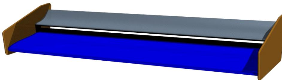
Abb. 1: Der Dopelement-Flügel (blau: großer Flügel, grau: kleiner Flügel, braun: Endplatten)
