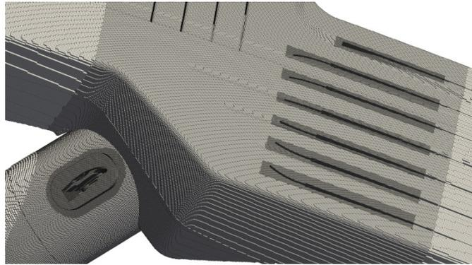
Abb. 3: Volumenzellen des Modells. In den Mittelpunkten der würfelförmigen Volumenzellen befinden sich die Kollisionszentren.
