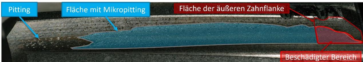
Abb. 6: Bewerteter Zahn von Planet 4 aus Getriebe 3 mit der folgenden Klassifizierung: Pitting, schwach; Mikropitting, mittel; Beschädigung Oberfläche der Zahnflanke, zwischen 50% und 75%; Beschädigung Oberfläche der äußeren Zahnflanke, zwischen 50% und 75%
