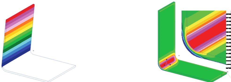
Abb. 5: L-Profil Spring-in-Verformung und Eigenspannungen
