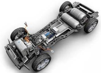
Plattform eines Brennstoffzellenfahrzeugs mit zwei Wasserstoff-Hochdruckbehältern (Adam Opel GmbH)
