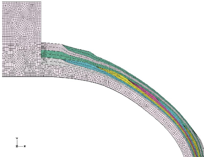
Abb. 12 Axialsymmetrisches 2D-FE-Netz eines Hochdrucktanks (Dombereich)
