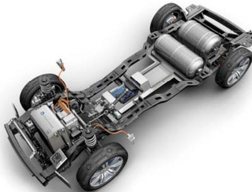
Abb. 14 Plattform eines Brennstoffzellenfahrzeugs mit zwei Wasserstoff-Hochdruckbehältern
